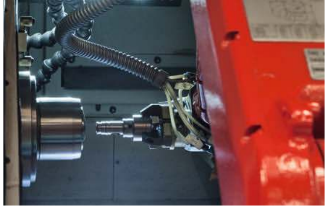
5 Präzision im Minutentakt: Das Ausblasen des Spannfutters und das exakt reproduzierbare Greifen und Einführen der Rohteile sind für µm-genaue Serienteile, wie bei Metabo gefordert, einfach obligat
