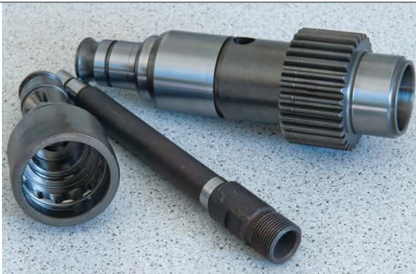
2 Präzision macht den Unterschied: Bei einer Härte von 62 HRC darf die Zylinderform der Innenbohrungen der SDS-Werkzeugaufnahmhülse respektive der Bohrhülse auf 50 mm Tiefe prozessstabil maximal um 8 µm tolerieren
