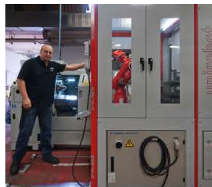
3 Eins, zwei, drei – und der Arbeitsraum ist frei: Die Automationslösung FMB Unirobot lässt sich auf bodenverankerten Rollenführungen innerhalb von Sekunden leicht wie präzise manuell verfahren
