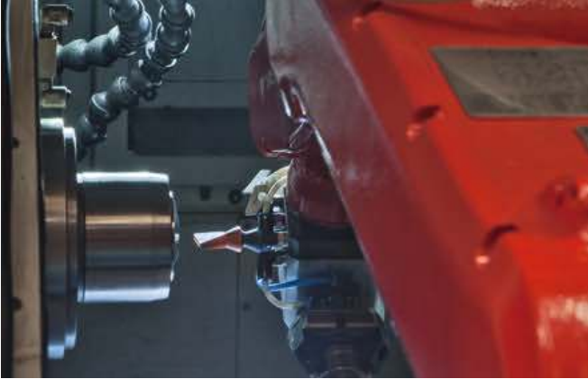
5 Präzision im Minutentakt: Das Ausblasen des Spannfutters und das exakt reproduzierbare Greifen und Einführen der Rohteile sind für µm-genaue Serienteile, wie bei Metabo gefordert, einfach obligat
